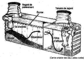
La fosse septique retient la partie solide de l'eau usée et amorce sa décomposition. Les solides les plus lourds se déposent au fond de la fosse septique sous forme de boues, alors que les plus légers flottent à la surface sous forme d'écume.
